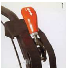
Schnellumschaltung Vorwärts-Retour durch Wendegetriebe
