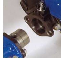
Schnellanschlüsse für einen schnellen Werkzeugwechsel
