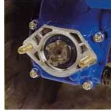
Unabhängige Zapfwelle Mit wartungsfreier Ölbad- kupplung.
