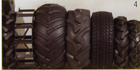
Luftreifen oder Gitterräder mit unterschiedlichen Profilen für unter- schiedliche Einsatzarten.
