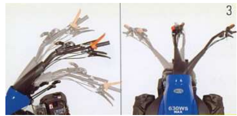
Bequeme Führungsposition mit ergonomisch angeordneten Bedienelementen. Die Führungs- holme besitzen eine Quer- und Höhenverstellung. Durch besondere Silent-Block Lagerungen werden Vibrationen zum Führungsholm hin optimal gedämpft.
