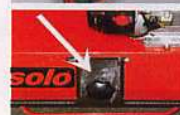
Stufenlos einstellbare Arbeitstiefe von 0 - 30 mm. Der federnd gelagerte Frontbügel hebt bei Widerstand den SOLO Vertikutierer an.
