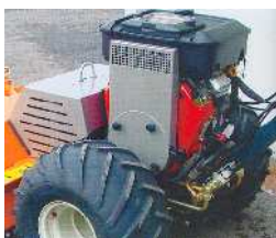
Kühlluftansaugung in staubarmer Höhe
