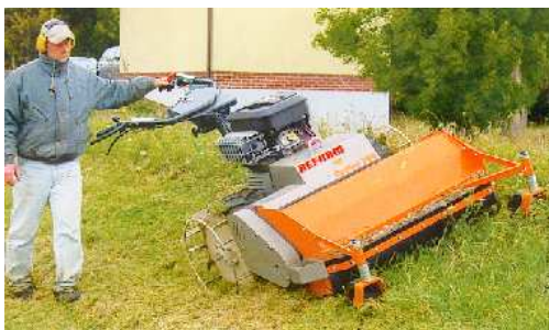
Der seiten- und höhenverstellbare Holm erlaubt in jeder Situation ein angenehmes Führen der Maschine.
