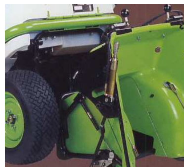
Schnelles abmontieren des Fangkorbes H100D
