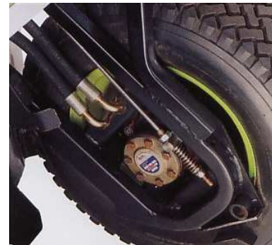
Keine Hinterachse Antrieb durch Radmotoren
