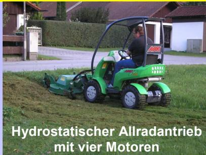
Hydrostatischer Allradantrieb mit vier Motoren
